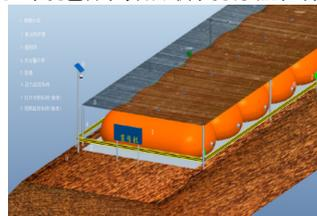
图 4-1 路基水袋堆载系统工作效果
